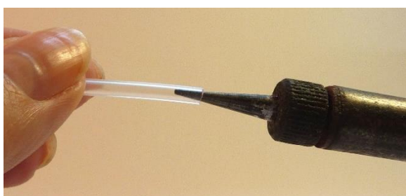
Р и с. 7. Прогревание внутренней стороны трубочки паяльником.
