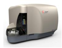
В зависимости от конфигурации Navios оснащен 2 или 3 лазерами, обеспечивающими анализ до 10 флуорохромов одновременно. Загрузка образцов из пробирок осуществляется автоматически с помощью карусельного модуля. Запатентованный миксер перемешивает образец в каждой пробирке непосредственно перед анализом.
